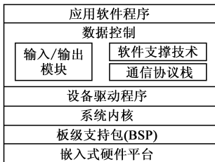
图6 物联网软件分层体系结构
